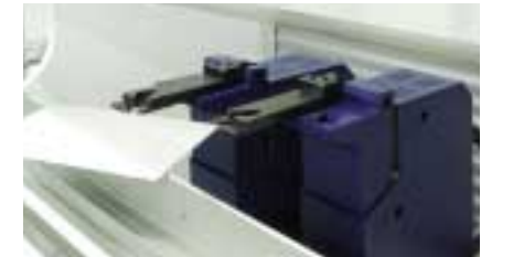
TruBend 5000/3000 Series 強靭なフレームと最先端の角度センサ技術をもったベンディングマシン
